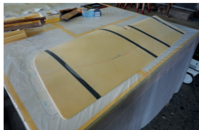
Der Neuaufbau eines Ruderblattes kann notwendig werden, wenn das alte feucht oder sogar richtig nass ist. Das neue Ruderblatt steht den seriengefertigten Produkten in Nichts nach.
